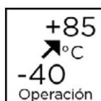
**Ensayo Ad de frío:** EN 60068-2-1 (2007). 16 horas de aire frío a -40 °C
