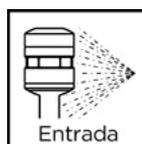
**Protección de entrada:** ISO 20653:2013 IPX6K EN 60529 (1992+A2:2103). Sellado a IPX6K, IP66 e IP67. Protegido contra chorros de agua a gran velocidad con aumento de presión, acceso a partes peligrosas y contra objetos sólidos extraños. SSe ha sumergido en agua a un metro de profundidad durante 30 minutos y se ha expuesto a una cámara de polvo durante 8 horas.
